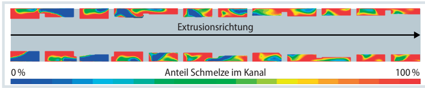
Bild 4. Kanalschnitt der Simulation im Aufschmelzbereich der Schnecke
